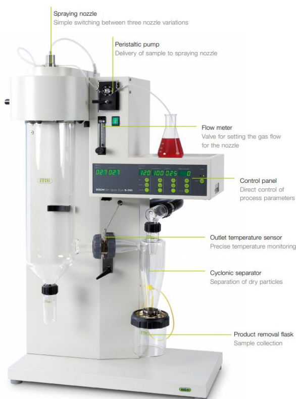
Figure 5: Büchi Mini Spray Dryer B-290 (Büchi, 2021).
